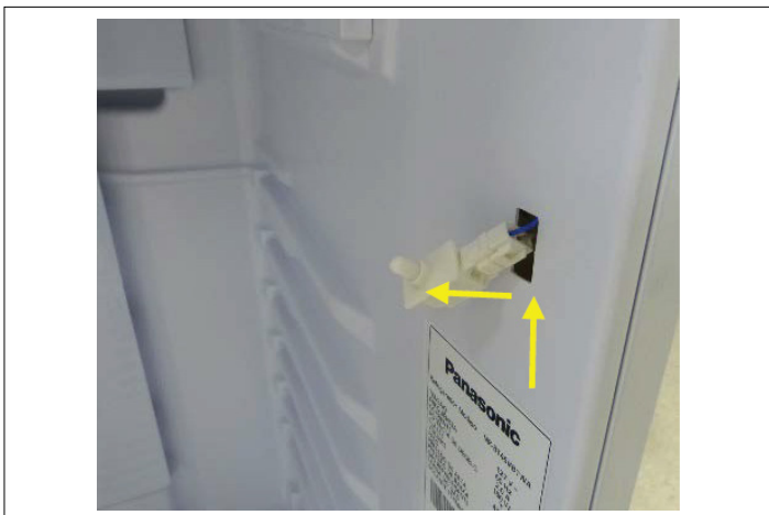
35 – Retire o interruptor da porta, utilizando uma chave de fenda deslocando o interruptor para fora.
