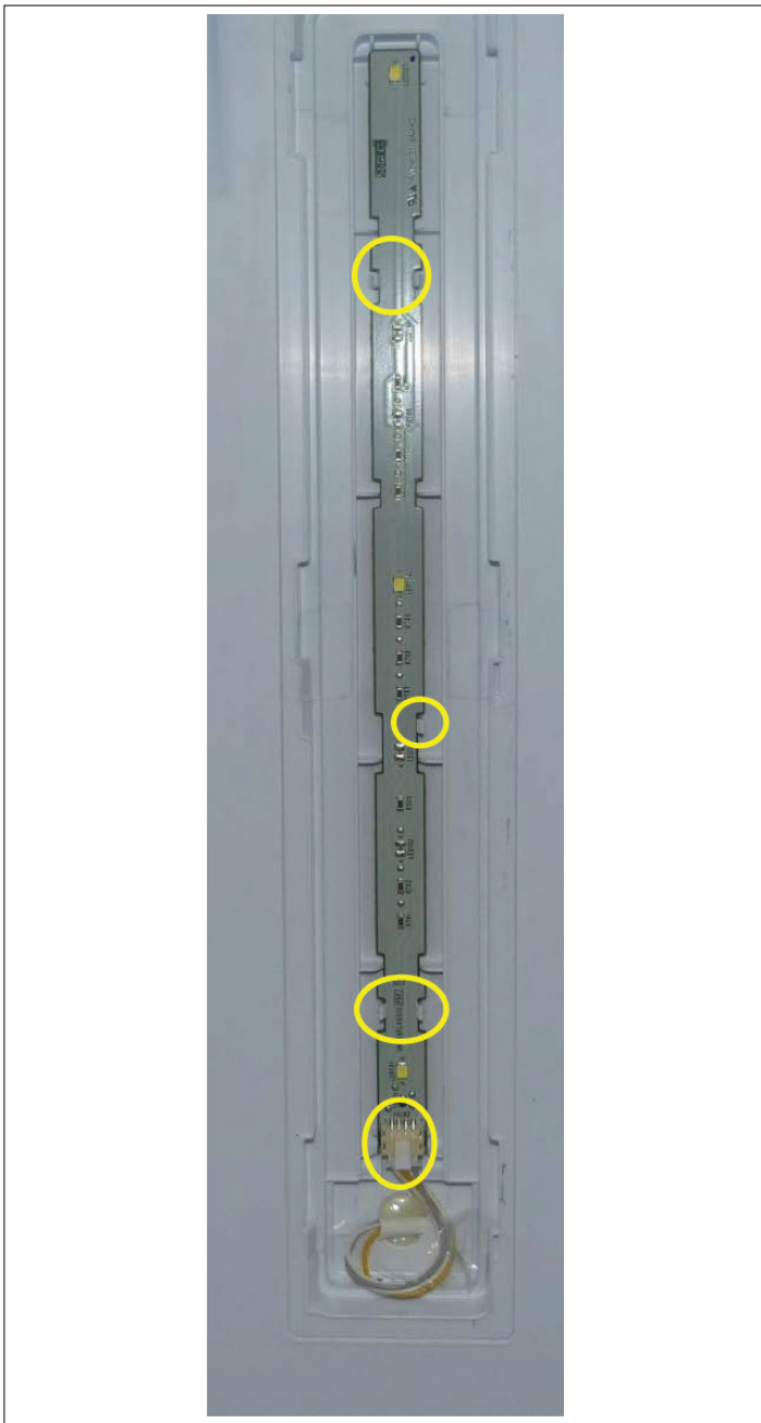
34 – Solte as travas que prendem a placa na caixa e pressione o conector para desconectar o cabo.
